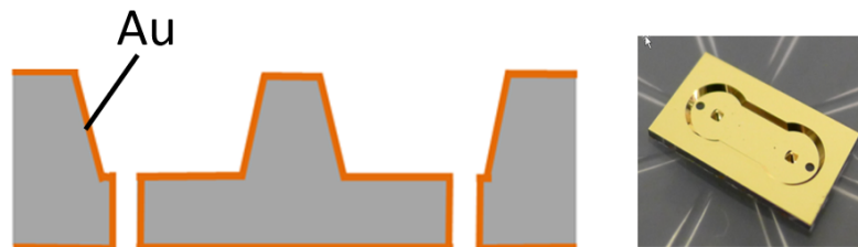
Fig. 2.13. Cavity fabrication step 3: Au deposition.
