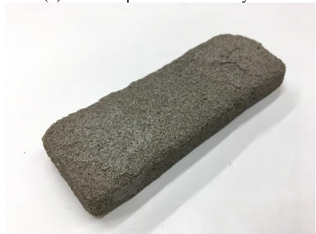
(d) AE CSC mortar-55% agg. at 300 F/T cycles
