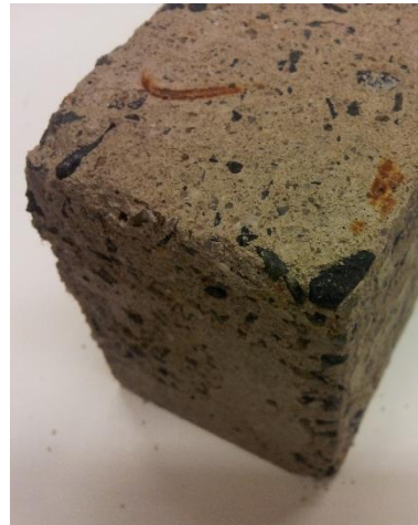
(d) AE CSCC-crushed aggregate at 575 F/T cycles
