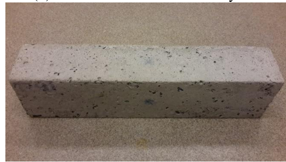
(d) AE CSCC after 300 F/T cycles
